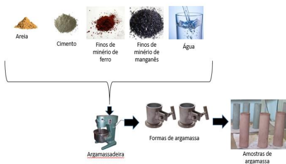
Figura 1: Metodologia aplicada na obtenção dos corpos de prova de argamassa.
